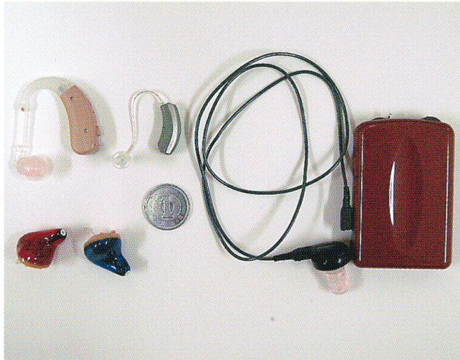
補聴器は用途によって3種類に大別される。耳かけ型（左上）、耳穴型（左下）、ポケット型（右）
